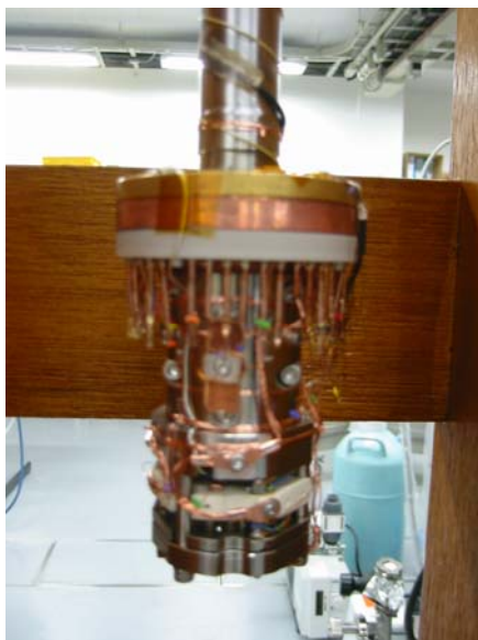
図1 今回試作した STM-IETS 装置の概略
