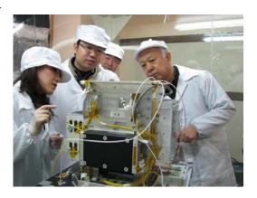
■ 理学研究科および工学研究科の学内協力により、50cm 立方、約50kg の小型科学観測衛星の開発を進めている。H-IIA ロケットによるGOSAT 相乗り打ち上げに採択され、フライトモデルを開発中。
