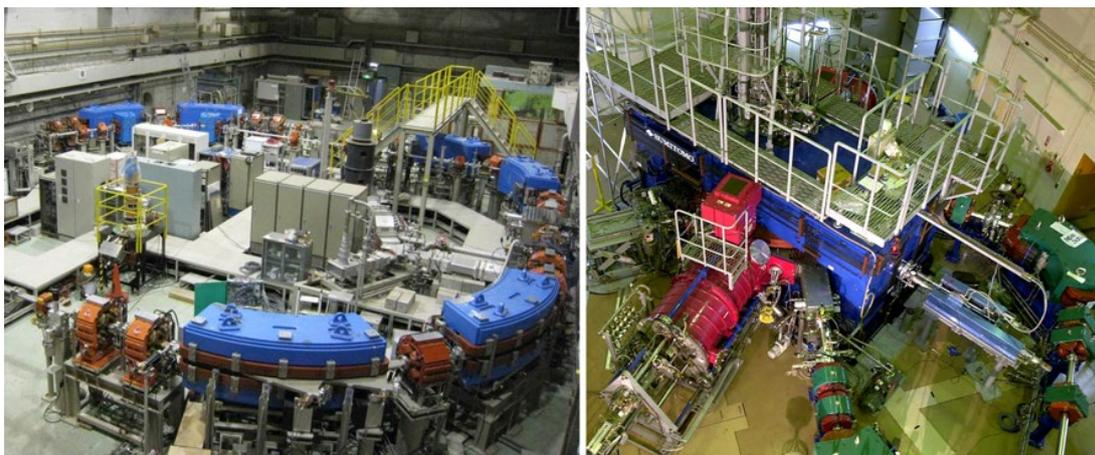
図. 先端量子ビーム科学研究センターが保有する（左）高エネルギー電子シンクロトロンと（右）大型サイクロトロン。これら加速器を駆使し、短寿命 RI を利用・活用した基礎科学から応用研究まで幅広い研究を展開します。
