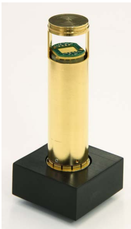
図 1: 今回開発した小型の断熱消磁冷凍機 (ADR)。
