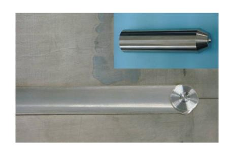
【写真】今回、実用化したコバルト合金製 FSW ツール(右上)と Ti-6AI-4V 合金の接合の例
