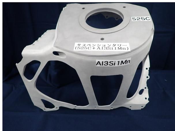
図 3. L-PBF 法を用いて作製した自動車部材（サスペンションタワー）
