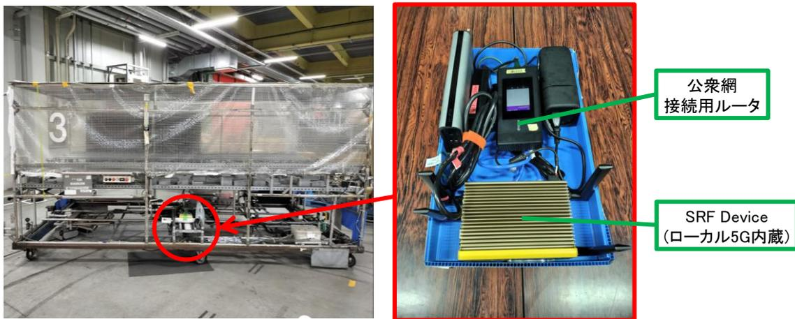
図 2 SRF Device を搭載した移動体(自動搬送車)
