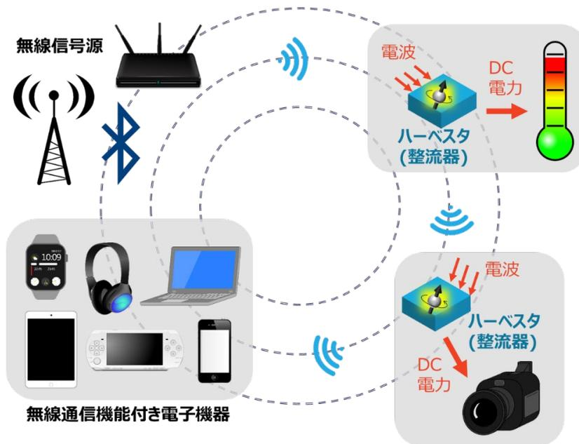
図 1. 無線通信の高周波 (RF) 信号を用いた環境発電の模式図。RF 信号は通常は PC やスマートフォンなどの無線通信機能付きの電子機器で利用されているが、それ以外の部分を用いて発電を行い、温度センサーや小型カメラなどのエッジ端末を駆動することで、IoT (モノのインターネット) 社会のより一層の発展を促進できるものと期待される。
