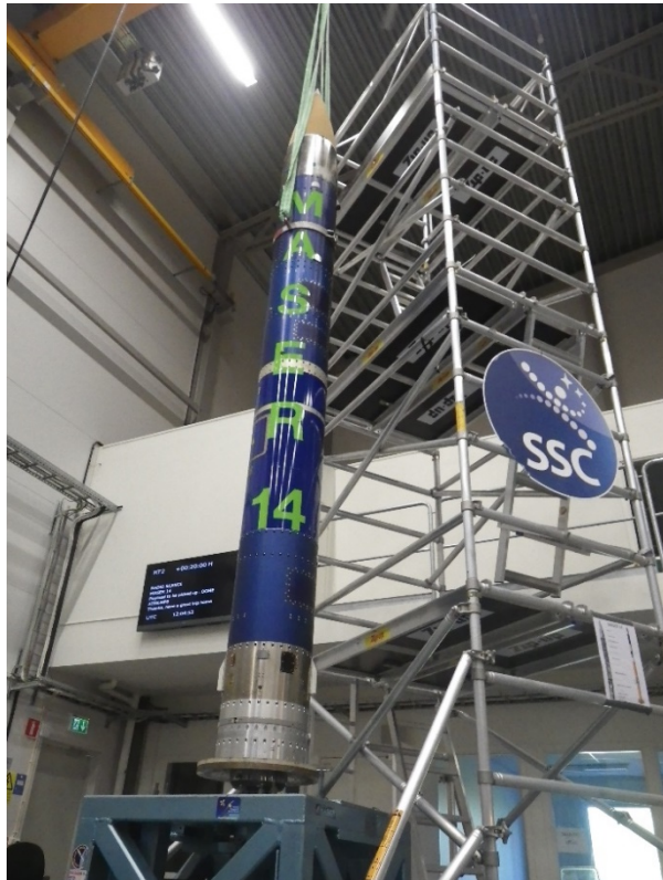
図 1. スウェーデン、キルナのエスレンジで打ち上げ準備中のスウェーデン宇宙公社の観測ロケット MASER 14。実験装置は M と A の文字の位置に搭載されている。
