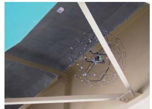
橋梁の桁間に入り点検するドローン
