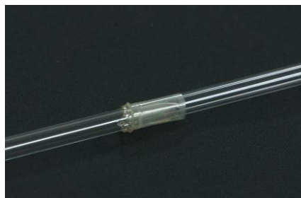
液晶用に開発した極薄ポリイミド透明基板(左)と、試作した液晶デバイスをガラス棒に巻き付けた耐久試験の様子(右)。
