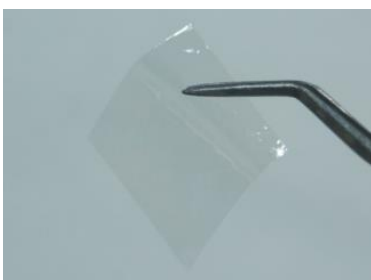
液晶用に開発した極薄ポリイミド透明基板(左)と、試作した液晶デバイスをガラス棒に巻き付けた耐久試験の様子(右)。
