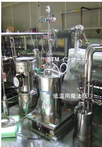
図2 開発された強磁場用走査トンネル顕微鏡
