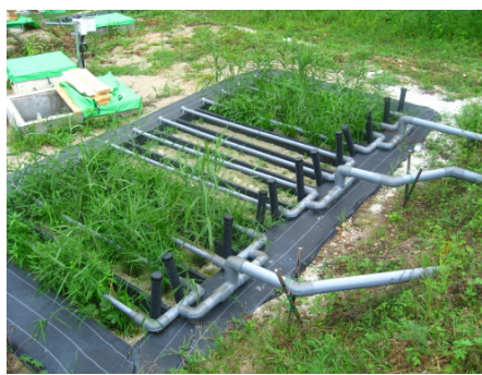
図2 人工湿地はヨシを植栽した 15-70cm 厚のろ過層で構成されており、ろ過層における物理的なる過・吸着による汚濁成分の捕捉とヨシ根圏微生物群による汚濁の生物学的分解の2段階の作用で水質浄化が行われます。
